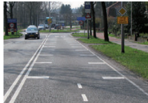
Abb. 26: oben: Geschwindigkeitsdämpfende Markierung eines Knotens, Birmingham, Quelle: A. Birth, S. Birth, B. Demgensky & G. Sieber (2011).
